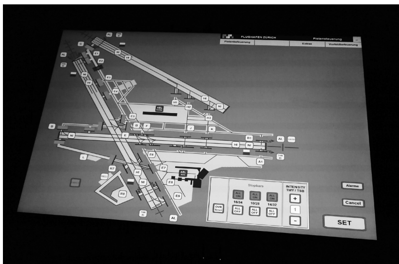
Das Panel für die Steuerung der Beleuchtungssysteme.
