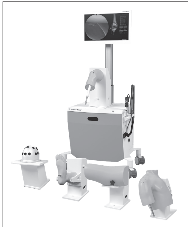
Die Plattform für Arthroskopie-Simulation mit den verschiedenen Modulen. Links unten ist das Basis-Modul FAST abgebildet.
