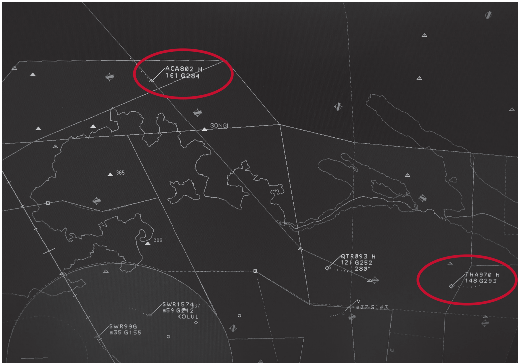
ACA802 auf der «RILAX 1A». Dabei besteht Vertikalstaffelung zur THA970 im AMIKI-Holding.
